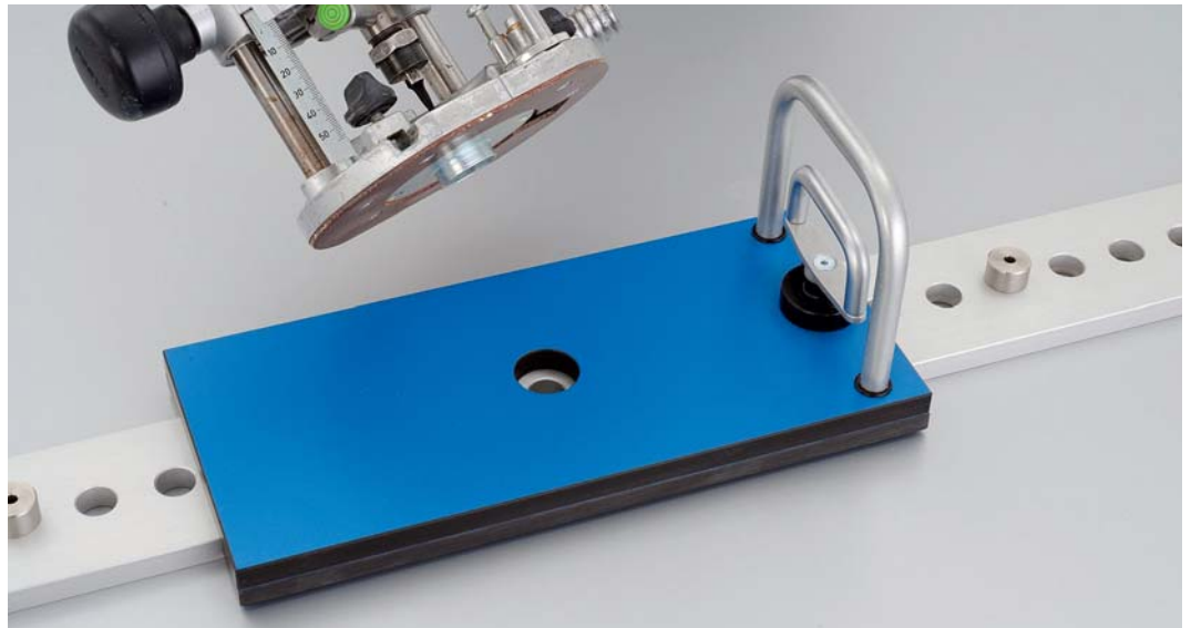
Zwischen den beliebig einsteckbaren Anschlagbolzen wird die Lochreihe gefräst. Dank Rasterbolzen mit Federzug kann der Schiebereiter einhändig auf der Schiene verschoben werden, während mit der anderen die Fräse bedient wird
