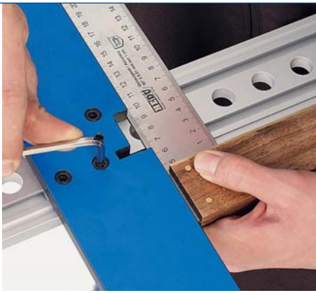
Die Montage von Schubladenausügen: Ein Rasterloch (m.) gibt den korrekten Abstand zur Kante vor. Der Anschlag wird im Winkel festgezogen (l.) und am Riss fixiert. Man bohrt die Löcher für die Euroschrauben mit dem Akkuschauber direkt durch die Anschlagbolzen (r.). Auszug anschrauben – fertig
